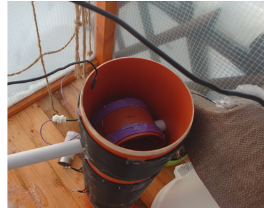
Das Variometer, durch drehen der Rotorspule verändert sich die Induktivität 230-460 uH
