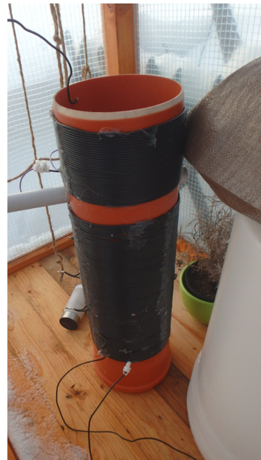
unten: Antennen Tuner gefertigt aus einem Polokalrohr im obere Bereich befindet sich das Variometer, die untere Wicklung mit den 4 Anzapfungen wird für die Impedanzanpassung an den Sender benötigt
