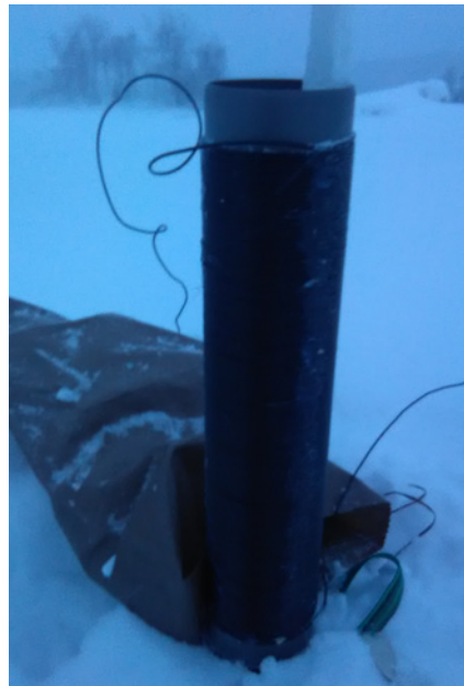
Ladespule gefertigt aus einem Polokalrohr mit 114 Wicklungen 1,5 mm2 Elektriker-Draht
