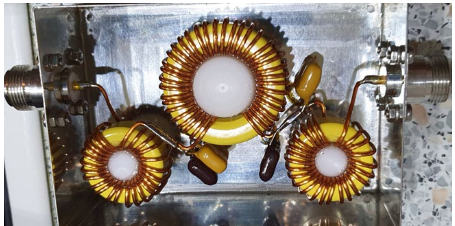
250W Tiefpass-Filter für das 630m Band
