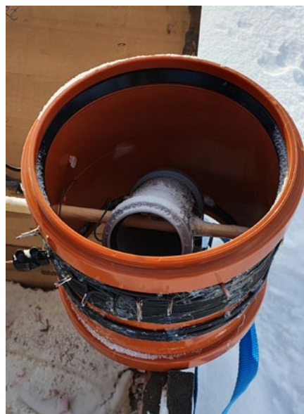
Variometer gebaut von OE3EMC 40 - ca. 100 uH, mit einer zusätzlichen Spule mit mehreren Anzapfungen für die Impedanzanpassung
